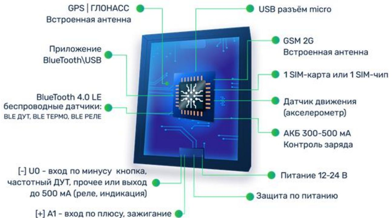
Навигационный контроллер L1 (далее «трекер») - компактное и функциональное устройство, предназначенное для дистанционного наблюдения за подвижными объектами и сбора данных с установленного на них оборудования.
