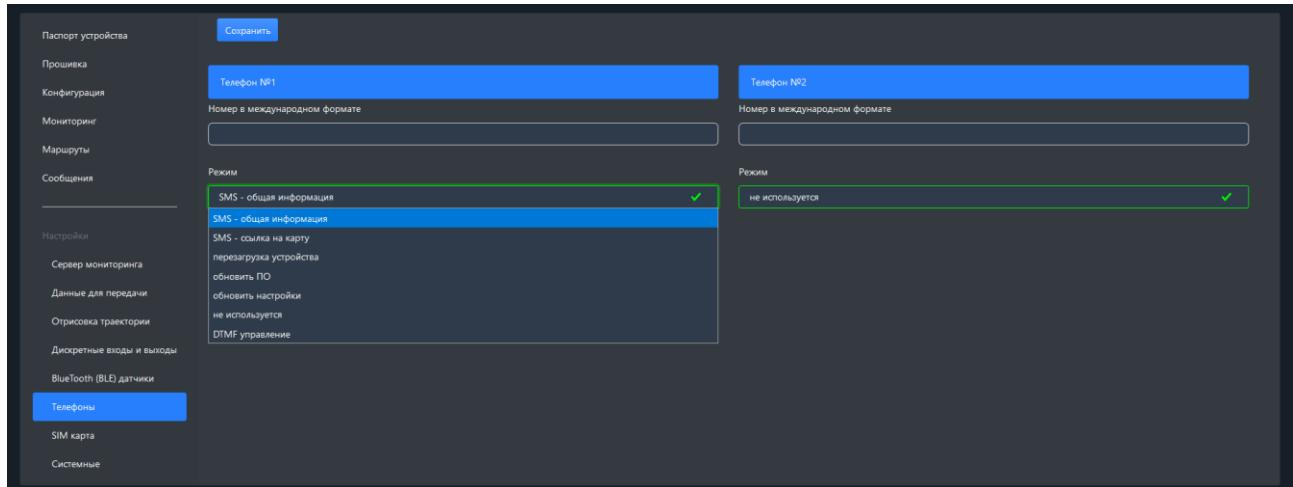
DTMF управление – позволяет с одного номера выполнять несколько функций. При звонке устройство поднимает трубку, далее на клавиатуре телефона нужно ввести код из таблицы, после чего устройство повесит трубку самостоятельно и выполнит команду.
